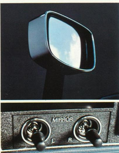
〈電動リモコン式フェンダーミラー〉運転席から左右のフェンダーミラーを操作できます。電動式ですから、操作ノブを軽く上下左右に動かすだけで、正確かつスピーディに視界調整ができます。デラックスに注文装備です。
