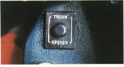
電磁式トランクオープナー>スイッチに軽くタッチするだけで運転席からトランクを開けられます。デラックスに標準装備。(デラックスA、スタンダードはケーブル式が注文装備)
